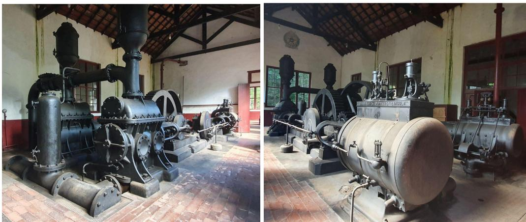
Figura 29 - Antigas bombas de distribuição de água da Cantareira. À esquerda a bomba a diesel (alemã) e à direita a bomba a vapor (inglesa), que foram utilizadas por um longo período para distribuir água para a cidade de São Paulo. Casa das Bombas, Núcleo Engordador.
